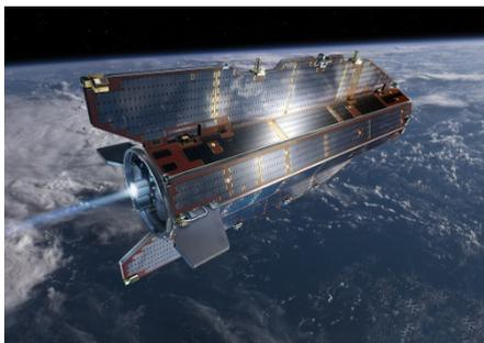
*Globale Schwerefeldmodelle* werden vor allem mit Hilfe der Raumfahrttechnik erstellt. Der Satellit GOCE umkreist die Erde seit 2009 und arbeitet wie eine große Wasserwaage. Mit seinen Messungen werden Schwerkraft- und Niveauunterschiede mit einer Auflösung von etwa 100 km bestimmt.
